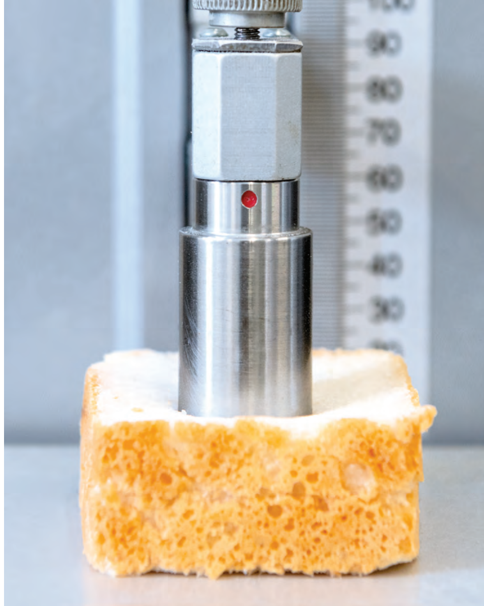
Food in the laboratory: The scientists take samples throughout the entire production process and investigate various properties of gluten-free materials such as their surface tension (left picture) or their strength and elasticity. Lebensmittel im Labor: Die Wissenschaftler nehmen Proben über den gesamten Produktionsprozess hinweg und untersuchen verschiedene Eigenschaften glutenfreier Materialien wie deren Oberflächenspannung (linkes Bild) oder deren Festigkeit und Elastizität.
